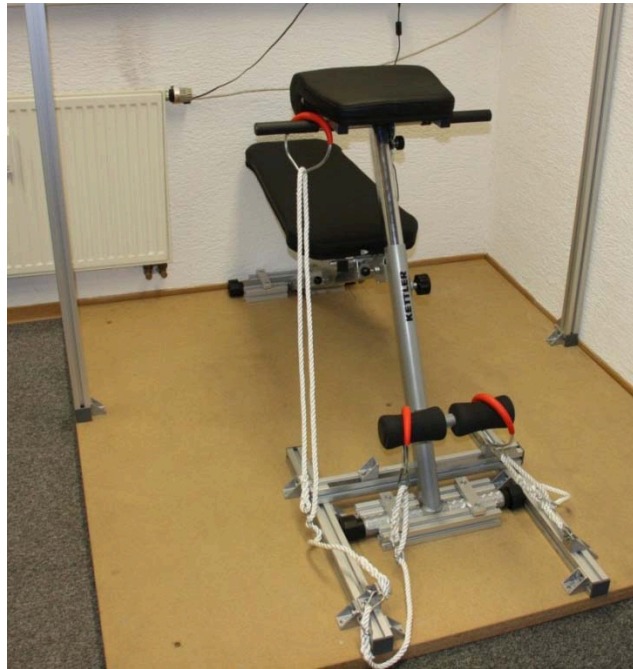
Abbildung 24: Apparatur zur MVC-Bestimmung auf Basis der Trainingsbank „Vario“ von Kettler (Kremer 2011)
